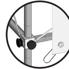
**1 ABLAGEN EINLEGEN 2 VINYL FOLIEN MITTELS DER ELASTISCHEN O-RINGE EINHÄNGEN**
