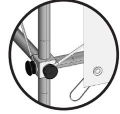
**1 ABLAGEN EINLEGEN 2 VINYLFOLIEN MITTELS DER ELASTISCHEN O-RINGE EINHÄNGEN**
